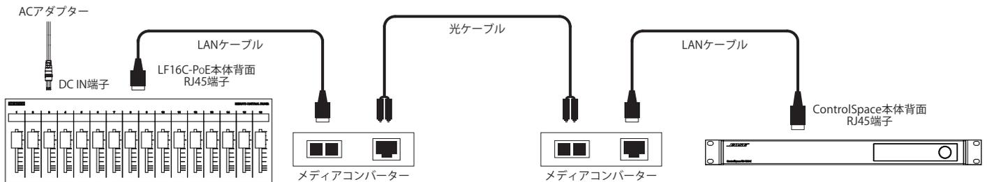
光ケーブルを使用する際は、光ケーブルを使用した接続例①の様にLF側、ControlSpace側の両側にネットワークスイッチを使用するか光ケーブルを使用した接続例②の様にLF-C間にメディアコンバーターのみをご使用ください。上記以外の接続で光ケーブルを使用した場合、正常に動作しない可能性がありますのでお気をつけ下さい。
