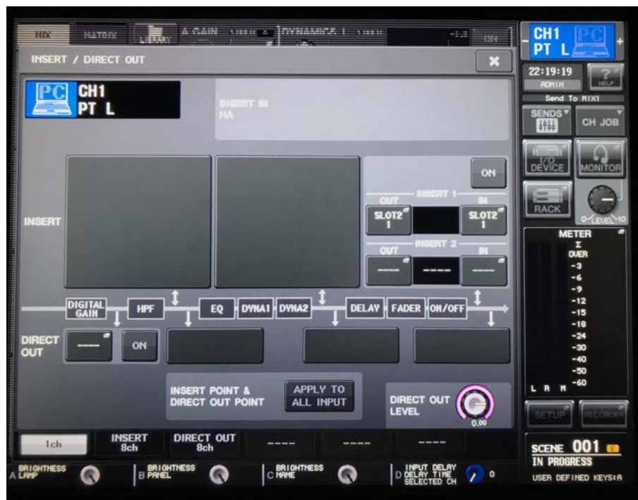
Figure 3-2 Dugan Speech System ヤマハデジタルミキサー SLO T 2 にポストフェーダー、ポストコンプレッサーインサートされています。コンプレッサーを使用する場合はコンプレッサーを INSERT 2 にパッチしてください。
