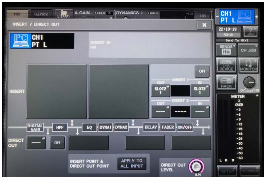
Figure 3-2 ヤマハデジタルミキサー上での Dugan スピーチシステムのインサート接続
