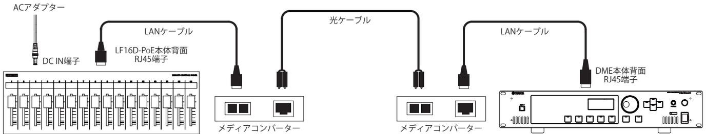
光ケーブルを使用する際は、光ケーブルを使用した接続例①の様にLF側、DME側の両側にネットワークスイッチを使用するか、光ケーブルを使用した接続例②の様にLF-DME間にメディアコンバーターのみをご使用ください。上記以外の接続で光ケーブルを使用した場合、正常に動作しない可能性がありますのでお気をつけ下さい。
